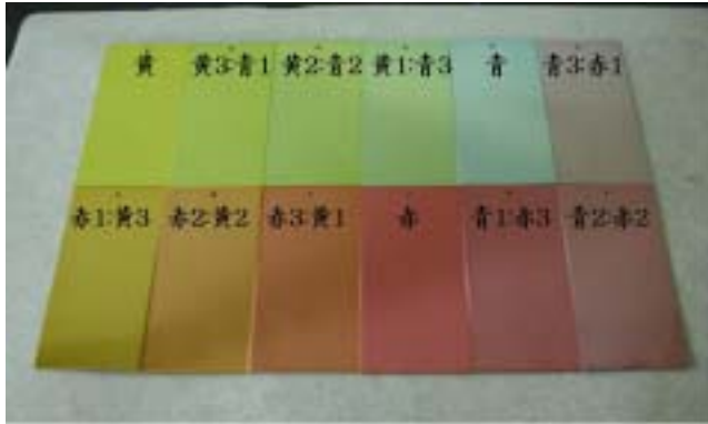
図1 12色の染料溶液による試作試験片 (素材：SUS304、塗料：焼付アクリルクリヤー塗料)
