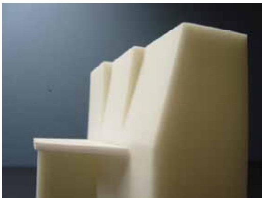
図2 デザイン検討用縮小モデル 直線で傾斜したデザインを採用するまでには前面パ
