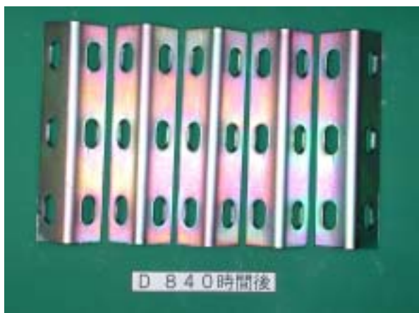
図2 試験片Dの塩水噴霧試験840時間後
