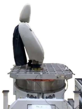
図1 振動耐久試験時の様子
