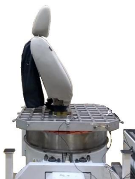
図1 振動耐久試験時の様子
