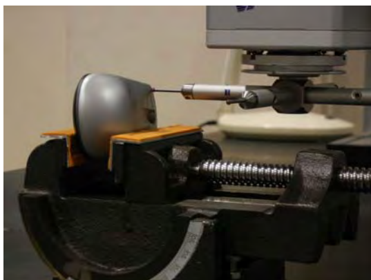
図 3 接触式三次元測定機による形状測定
