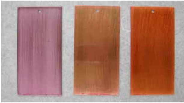
図1 焼付塗膜の赤色染色試験片 (左からステンレス、真鍮、銅)
