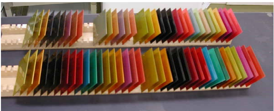
図3 試作試験片：上段がメラミン、下段がアクリル 左半分が5分浸漬染色、右半分が20分浸漬染色
