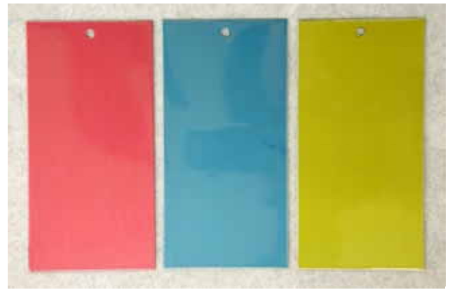
図2 常温乾燥型塗膜の染色試験片
