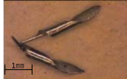
図5 切削屑, V=6.28 m/min f=40 mm/min A_d=1 mm Wet
