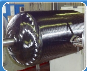
NEDO水素利用技術研究開発事業 によるType4 複合容器試作成形
