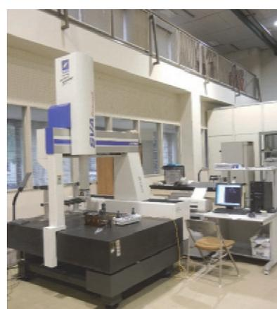
図1 接触式三次元測定機
