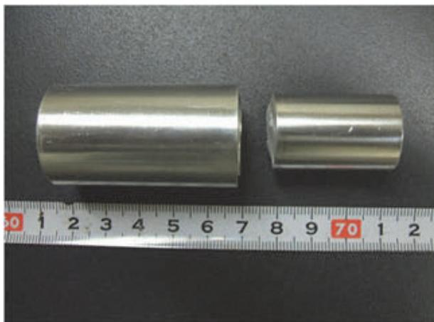
図 6 せん断試験後の試験片外観
