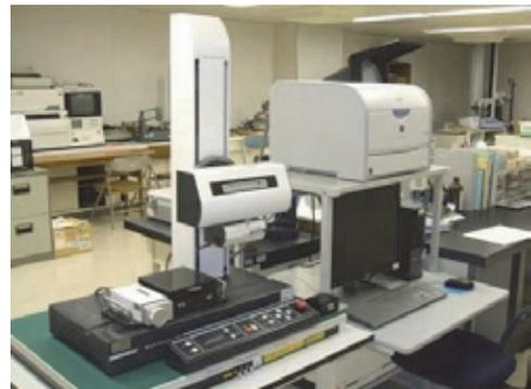
図 3 表面粗さ輪郭形状測定機
