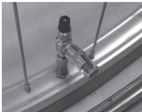
図7 車いす用空気圧インジケータ
