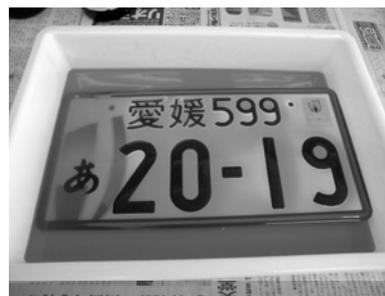
図 4 着色液による浸漬試験
