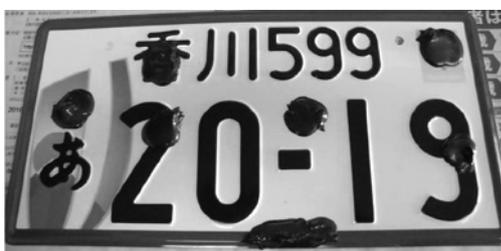
図 7 汚染物質による耐汚染性試験
