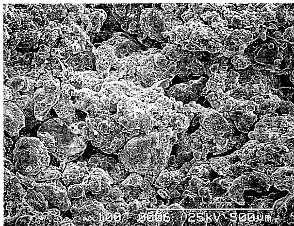
図4 集じんダスト破面（焼結温度1,100℃）
