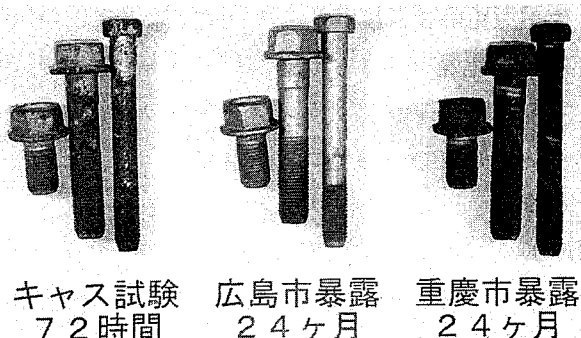
図11 ボルト類（ダクロダイズド処理）の暴露試験及びキヤス試験の比較
