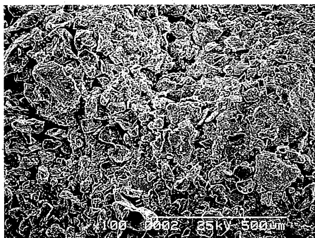
図1 ショット廃砂破面（焼結温度1,100℃）
