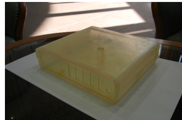
図2 3Dプリンターによるモデル製作 (4 パーツを組み立てたところ)
